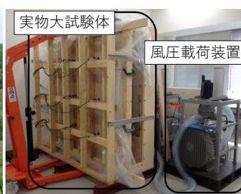
図2: 外装材耐力評価実験
