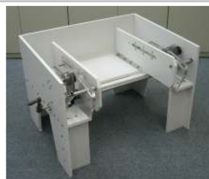
図1 椅子型起立支援ロボット
