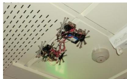
図2 橋梁検査ロボット
